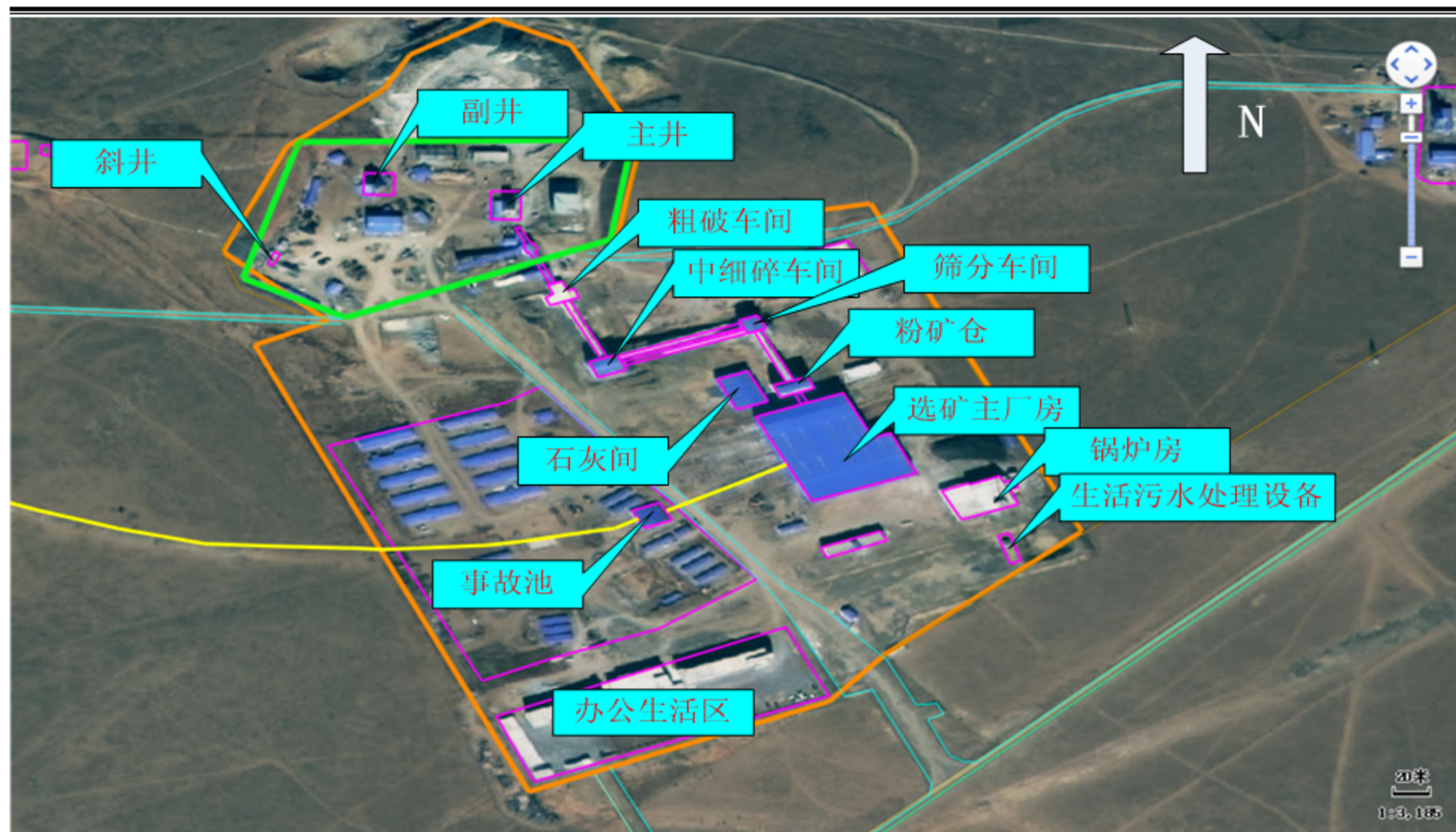
图 2.2-3 主副井工业场地、选矿工业场地平面布置图
