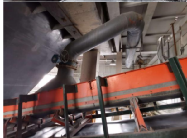
粉矿仓下部、球磨给矿皮带尾部集尘罩
